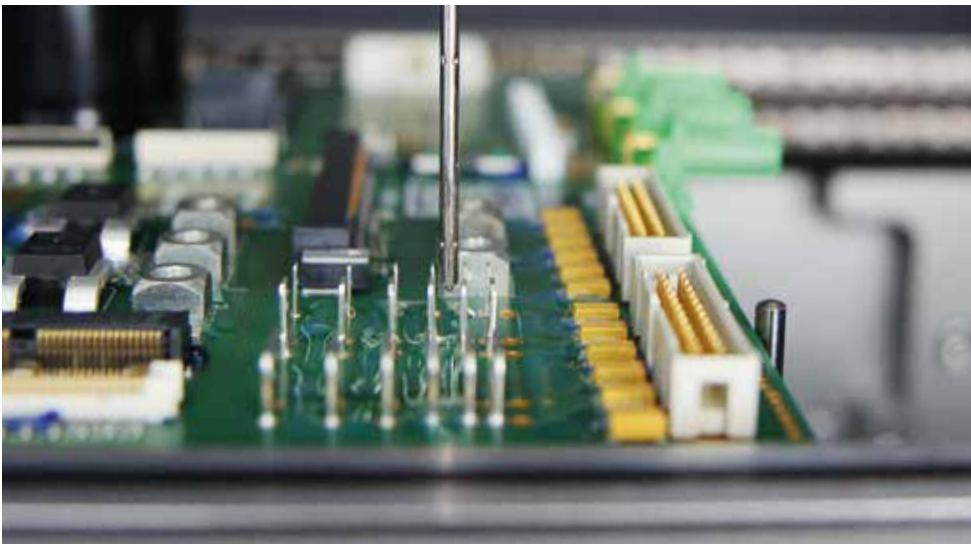
Präzises Beschichten der elektronischen Kontaktierung zwischen eng stehenden, hohen Bauteilen
