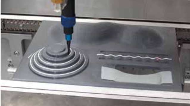
Präziser Materialauftrag bei komplexen Geometrien
